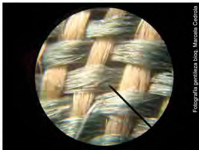
Imagen 5 Microfotografía de ligamento, 100X, Urdimbre blanca y trama celeste. Franja inferior celeste, borde inferior izquierdo, Bandera de Macha, Buenos Aires.
