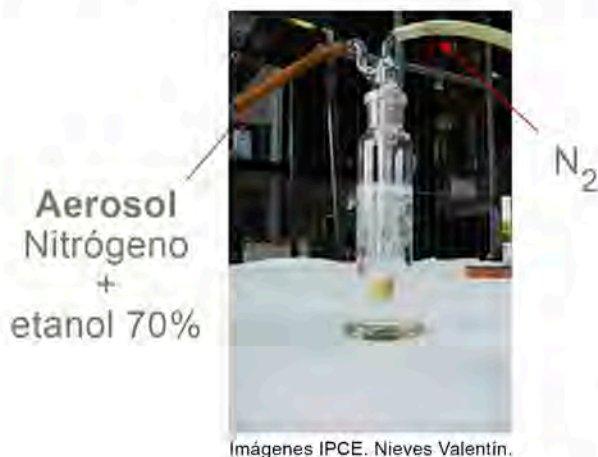
Figura 3 Nitrógeno burbujeando en etanol 70%.
